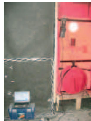
Blower Door test
